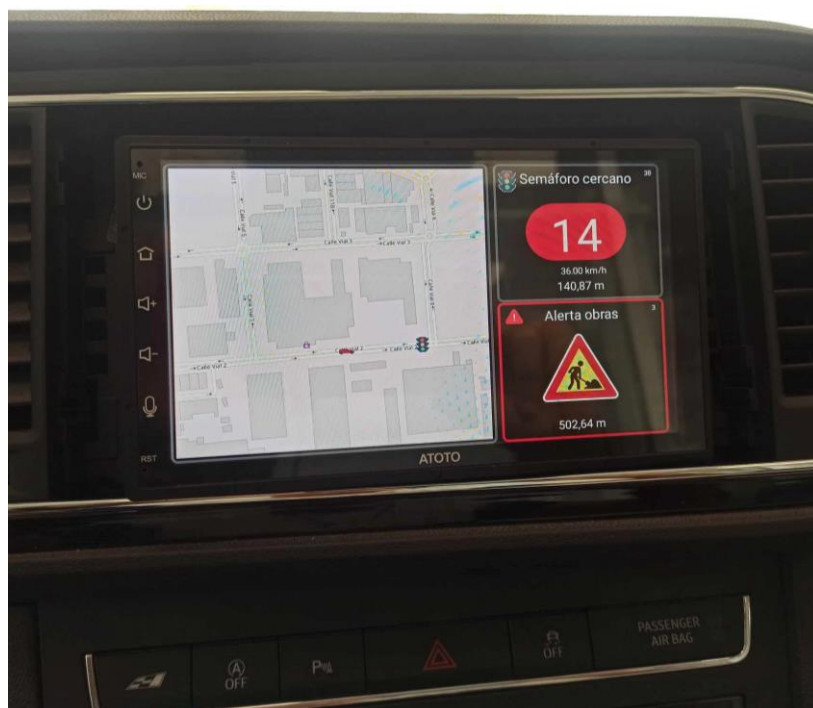
Figura 18. Ejemplo de cómo la aplicación muestra un semáforo inteligente en rojo y una alerta por obras
