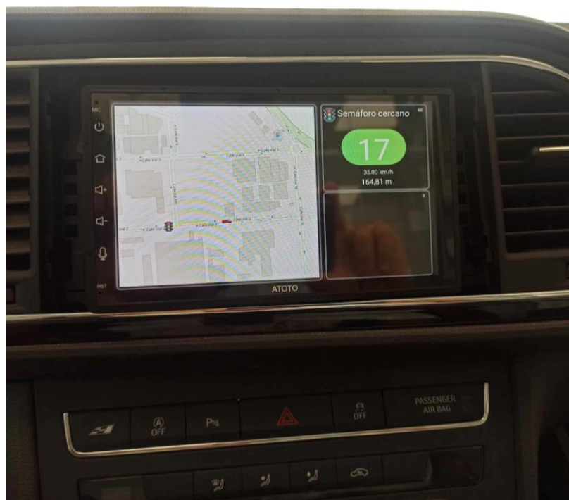
Figura 19. Ejemplo de cómo la aplicación muestra un semáforo inteligente en verde y sin alerta por obras
